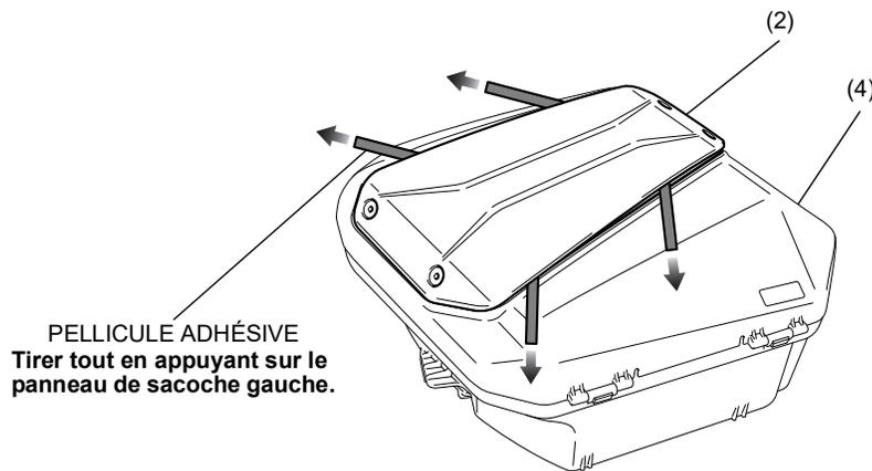
5. Appliquer une pression adéquate de 50 N (5 kgf) sur le panneau de sacoche gauche fixé, puis relâcher la pression adéquate et laisser le panneau de sacoche gauche pendant 10 minutes pour stabiliser l'ajustement de la surface adhésive.
